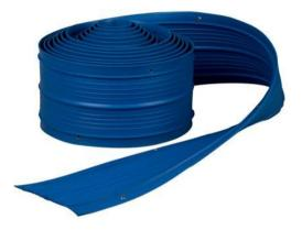
Ejemplo: En una junta de 1" donde el agregado máximo del concreto será de 3/4", el ancho mínimo de la banda debe ser:  $(6 \times 3/4$ ") + 1" =  $5 \cdot 1/2$ ". La Fester Banda no debe ser menor de  $5 \cdot 1/2$ ". Agregado máximo del concreto:
