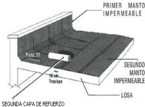
impermeabilizante asfáltico que corresponde (1 L/m<sup>2</sup>). Terminado el sistema, dejar secar durante 7 días para la aplicación del acabado reflectivo como protección del sistema. El Sistema reforzado queda conformado con dos capas de membrana de refuerzo y tres de impermeabilizante.
